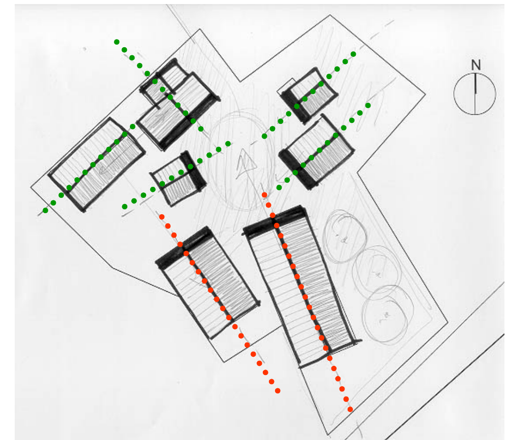
Nokken en kopgevels als ruimtevormende elementen
